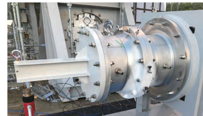
16B シップ・ショア・カップリング (SSC) の実液 (LH2) 試験
